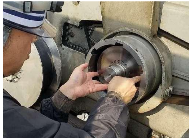
9-6 ブレーキパット及びディスクの組み込み
