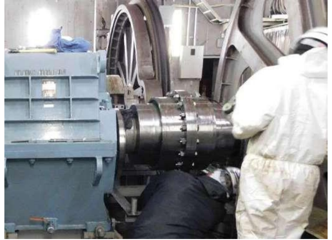
9-4 減速機－モーター間のギアカップリングを清掃した状態
