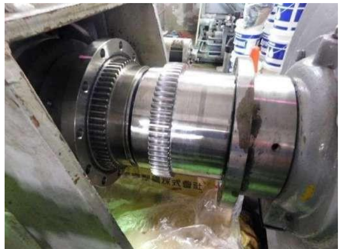
9-4 減速機－モーター間のギアカップリングを清掃した状態
