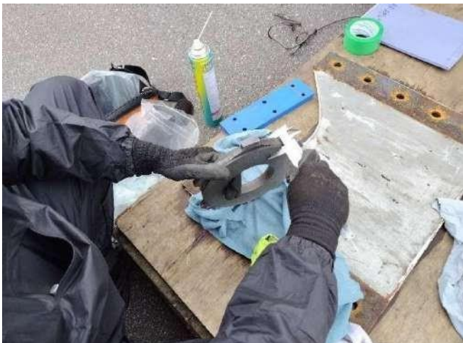
9-5 ブレーキパット及びディスクの摩耗量を測定
