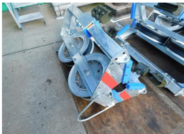
1.23 取付け前懸吊機
