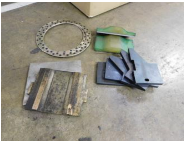
2.5 1号車イコライザー交換した部品
