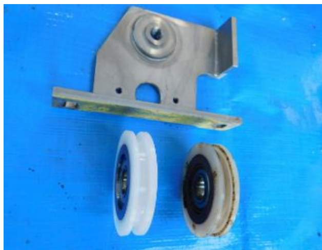
7.14 2号車外側扉上部コロ交換(摩耗)
