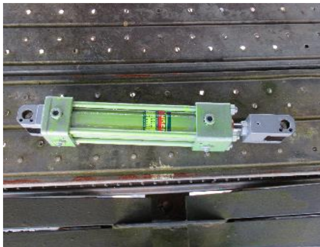
7.2 山頂せり橋油圧シリンダー交換(油漏れ)
