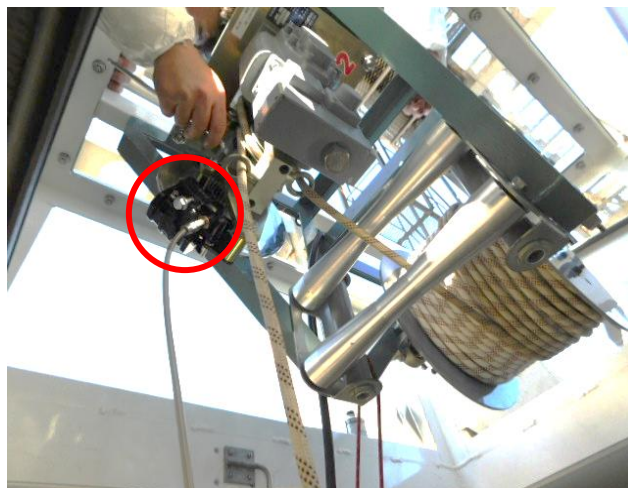
2.22 救助装置本体(ブレーキ取付け部)
