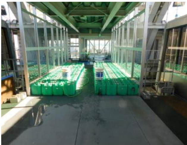
7.19 荷重試験用ポリタンクに水入れ(275個)
