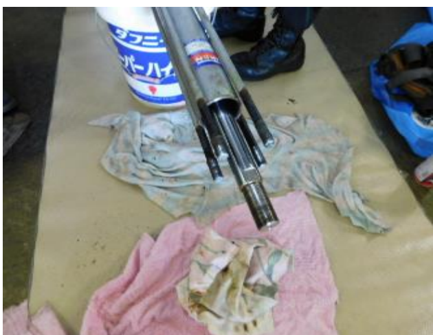
7.17 予備せり橋油圧シリンダーパッキン交換
