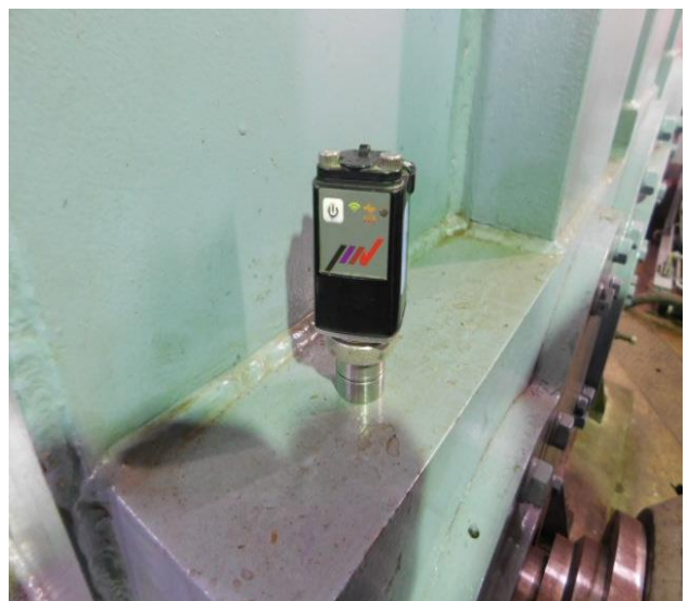
6.2 振動テスターによる数値測定(減速機)
