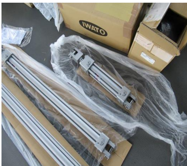
2.1 山頂 2 号外側油圧シリンダー交換
