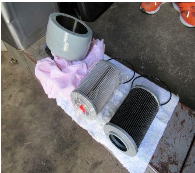
5.3 右側交換前、左新品取付前オイルフィルター
