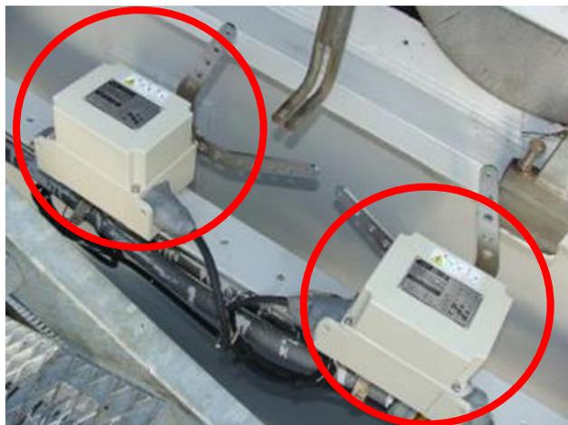
12.13 クランプ部圧搾リミッター交換作業
