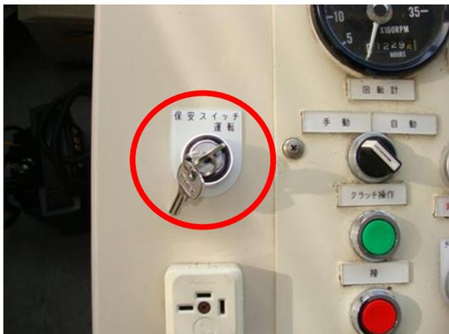
3.2 山麓シューフレームのクランプ油圧ユニット側面に設置したカバー付きの保安スイッチ
